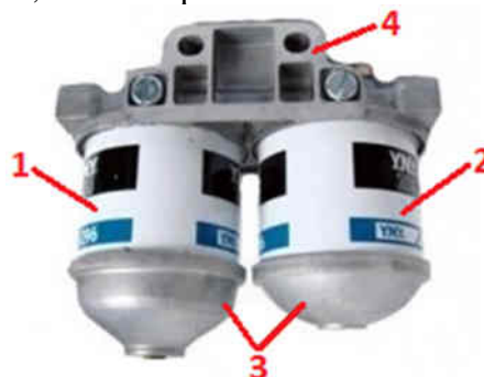
Fig. 4.33 – Baterie de filtre de combustibil: 1 – filtru brut; 2 – filtru fin; 3 – capace; 4 – corp
