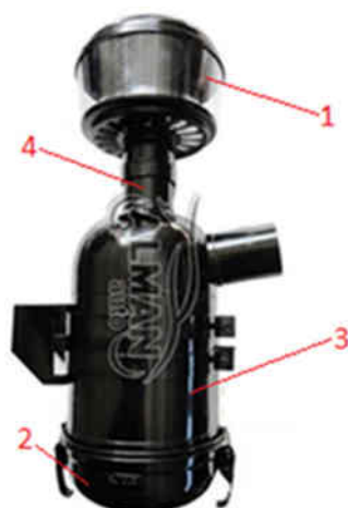
Fig. 4.34 – Schema filtrului de aer combinat: 1 – prefiltru; 2 – baie de ulei; 3 – filtru cu element filtrant; 4 – tub central
